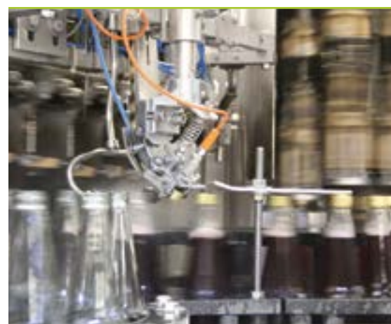
In der gesamten Produktion wird auf modernste Technik gesetzt. Hier schraubt ein Roboter die Verschlüsse auf die Flaschen. In der Stunde werden so rund 10.000 Flaschen geschafft.
