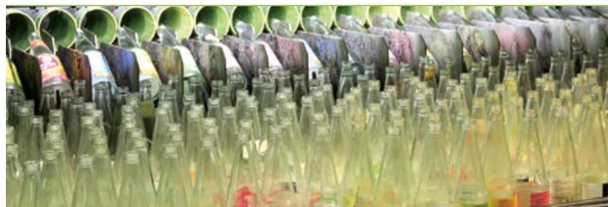
Bis zu 200.000 Flaschen werden hier am Tag gereinigt und vom Etikett befreit.
